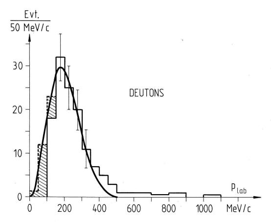
Figure 2 Spectre d'impulsion des deutons. L'histogramme en trait plein représente nos résultats. La courbe (voir texte) est le résultat d'une adaptation du type  $dN/dp = Ap^2 \exp{(-\alpha p^2)}$ . La surface hachurée représente les pertes dues aux deutons de faible impulsion.
