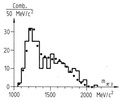
Figure 6 Distribution des masses effectives  $\pi^{\pm}p$  pour les 'protons rapides'. L'histogramme représente nos résultats, les points résultent d'un calcul de Monte-Carlo basé sur 90% d'événements  $\pi n \to \Delta(1232) \pi$  et 10% d'événements  $\pi n \to \rho p$ .
