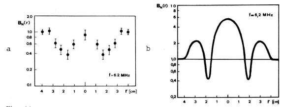
Figur 14 Radialer Amplitudenverlauf bei f = 6.2 MHz; (a) Gemessen bei  $t = 80 \,\mu\text{s}$ , (b) Berechnet.
