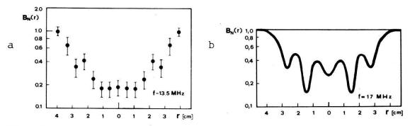
Figur 15 Radialer Amplitudenverlauf; (a) Gemessen bei  $t = 80 \mu \text{s} \text{ und } f = 13.5 \text{ MHz}$ , (b) Berechnet bei f = 17 MHz.
