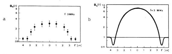
Figur 13 Radialer Amplitudenverlauf bei f = 3 MHz; (a) Gemessen bei  $t = 80 \mu s$ , (b) Berechnet.
