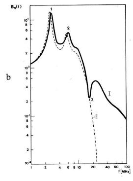
Figur 10 Wellenfeld in Abhängigkeit von der Frequenz f; (a) Messung bei  $t=80\,\mu s$ , (b) Berechnung. I Plasma endlicher Länge, II Unendlich langes Plasma, 1 erste magnetoakustische Resonanz, 2 zweite magnetoakustische Resonanz, 3 Minimum.
