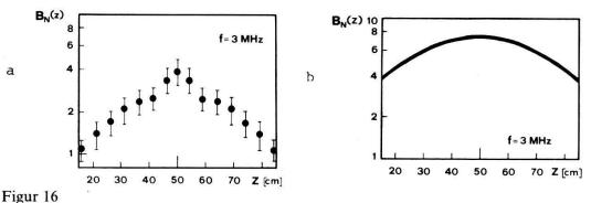
Axialer Amplitudenverlauf bei f = 3 MHz; (a) Gemessen bei  $t = 80 \,\mu\text{s}$ , (b) Berechnet.
