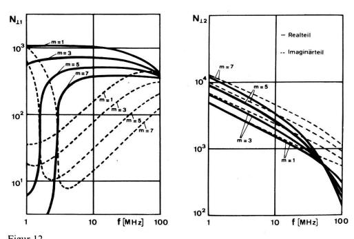
Figur 12 Brechungsindex senkrecht zum äusseren Magnetfeld in Abhängigkeit von der Frequenz f und der axialen Wellenzahl.
