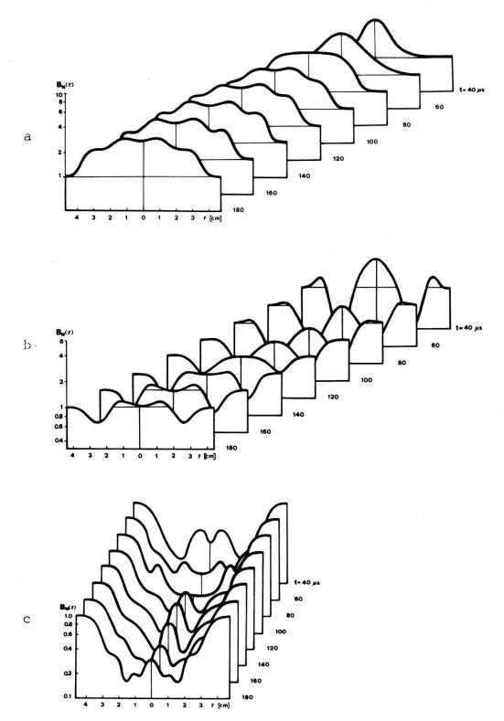
Figur 7 Gemessener radialer Amplitudenverlauf in Abhängigkeit von der Zeit t; (a) f = 3 MHz, (b) f = 6.2 MHz, (c) f = 13.5 MHz. (Von den Kurven der Figuren 7 und 8 wurde nur eine Seite ausgemessen, und es sind keine Fehler eingezeichnet.)
