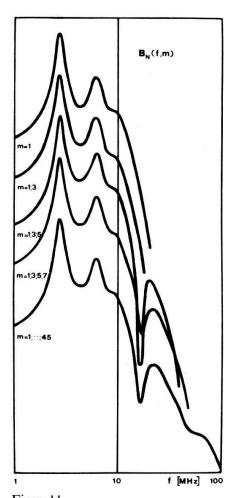
Figur 11 Berechneter Amplitudenverlauf in Abhängigkeit von der Frequenz f und der Anzahl der Fourierkomponenten.
