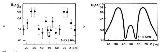
Figur 17 Axialer Amplitudenverlauf; (a) Gemessen bei  $t = 80 \mu \text{s} \text{ und } f = 13.5 \text{ MHz}$ , (b) Berechnet bei f = 17 MHz.
