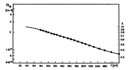
Figur 4a Zeitlicher Verlauf der Elektronendichte. x Ionisationsgrad.
