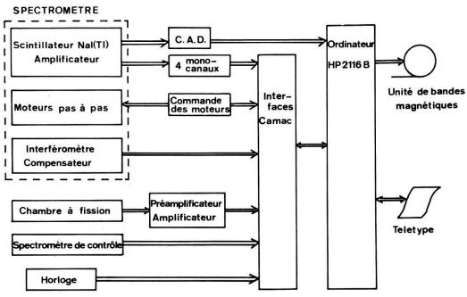
Figure 5 Configuration du système de commande et d'acquisition des données.
