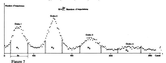
Exemple de spectre du scintillateur NaI(Tl) pour une position fixe du cristal.
