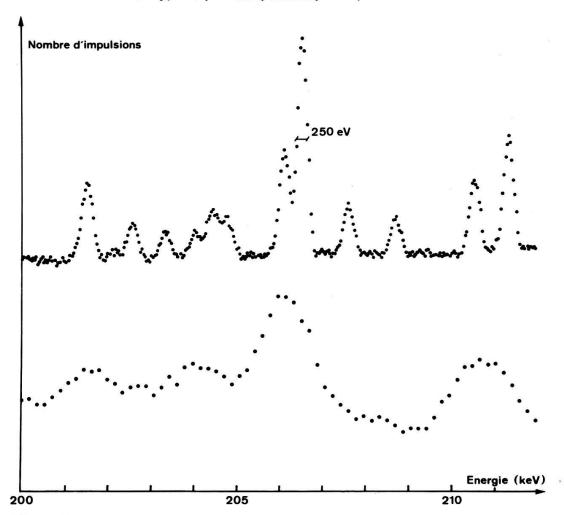
Figure 10 Comparaison de deux portions du spectre  $^{nat}Ir(n, \gamma)$  observé avec une diode Ge(Li) de 2,4 cm<sup>3</sup> (spectre inférieur) et avec le spectromètre à cristal incurvé (spectre supérieur) dans le deuxième ordre de réflexion.
