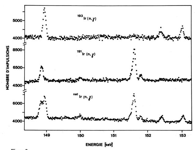
Trois portions des spectres <sup>191</sup>Ir $(n, \gamma)$ , <sup>193</sup>Ir $(n, \gamma)$  et <sup>nat</sup>Ir $(n, \gamma)$  observés dans le troisième ordre de réflexion.
