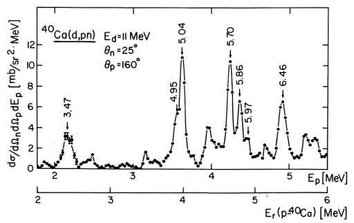
Figur 7 Protonenspektrum der Reaktion  ${}^{40}\text{Ca}(d,pn){}^{40}\text{Ca}$  (Endkern im Grundzustand), welches sich aus der Intensität längs der Kinematik im zweidimensionalen Spektrum ergibt. Die Resonanzen entsprechen Zuständen im  ${}^{41}\text{Sc}$  mit einer Anregungsenergie  $E_x = E_r (p^{-40}\text{Ca}) + 1,086 \text{ MeV} = \text{Relativenergie Proton-Endkern} + \text{Separationsenergie des Protons.}$
