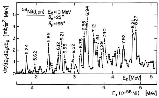
Figur 8 Protonenspektrum der Reaktion <sup>58</sup>Ni(d, pn)<sup>58</sup>Ni (Endkern im Grundzustand), welches sich aus der Intensität längs der Kinematik im zweidimensionalen Spektrum ergibt. Die Resonanzen entsprechen Zuständen im <sup>59</sup>Cu mit einer Anregungsenergie  $E_x = E_r$  (p-<sup>58</sup>Ni) + 3,417 MeV = Relativenergie Proton-Endkern + Separationsenergie des Protons.
