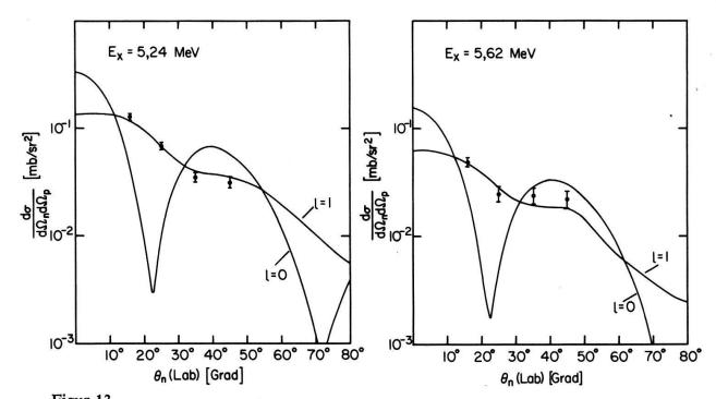
Figur 13 Neutronenwinkelverteilungen der Reaktion <sup>58</sup>Ni(d, n) <sup>59</sup>Cu im Falle der Resonanzen bei 5,24 MeV und 5,62 MeV welche eine isotrope Winkelkorrelation aufweisen. Die eingezeichneten Kurven entsprechen den DWBA-Rechnungen für l=0 und l=1. In beiden Fällen ergibt sich auf Grund der isotropen Winkelkorrelation (nur mit Spin 1/2 vereinbar) und der Neutronenwinkelabhängigkeit (l=1) $J^n=1/2^-$ .
