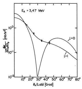
Figur 11 Neutronenwinkelabhängigkeit für die Reaktion  ${}^{40}$ Ca(d, n)  ${}^{41}$ Sc im Falle der 3,47 MeV Resonanz im  ${}^{41}$ Sc. Die eingezeichneten Kurven entsprechen den DWBA-Rechnungen für l=0 und l=1.
