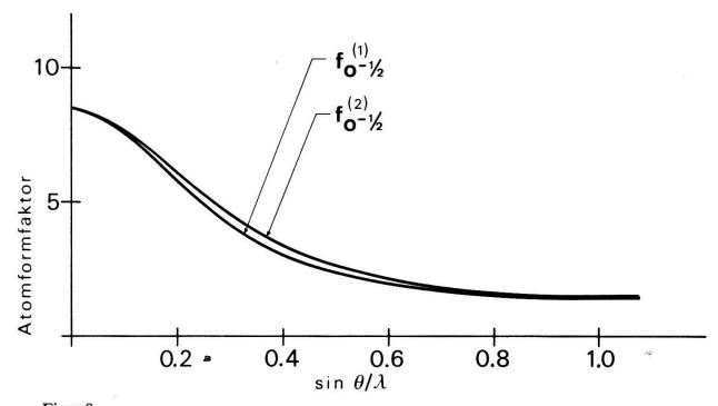
Figur 8 Gegenüberstellung der aus zwei verschiedenen Mittelungen bestimmten Atomformfaktoren für  $\mathrm{O}^{-1/2}$ .
