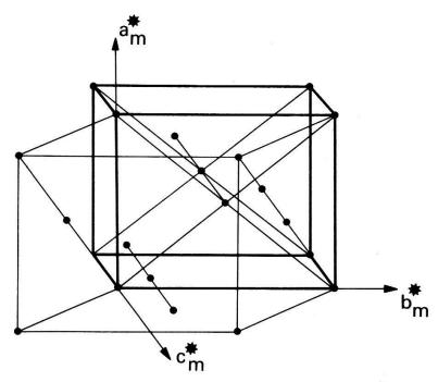
Figur 7b Ausschnitt aus dem reziproken Gitter einer einzigen Domäne mit reduzierter, monokliner Einheitszelle.
