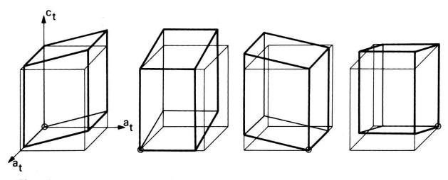
Figur 6 Auf vier verschiedene Arten gescherte tetragonale Einheitszelle, die durch Drehungen um 90° um die tetragonale Achse ineinander übergeführt werden können.
