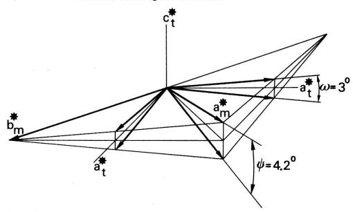
Figur 5 Aufspaltung der tetragonalen Achsen  $a_t^*$ , wie sie aus den Orientierungsaufnahmen bestimmt wurde, und Wahl eines monoklinen Achsensystems.
