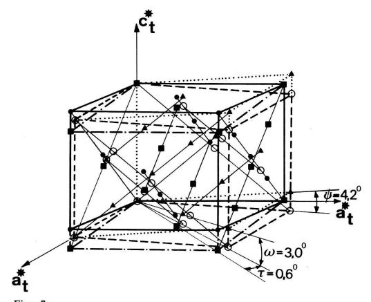
Figur 7a Ausschnitt aus dem reziproken Gitter des mehrdomänigen Kristalles. Reflexaufspaltung stark übertrieben.
