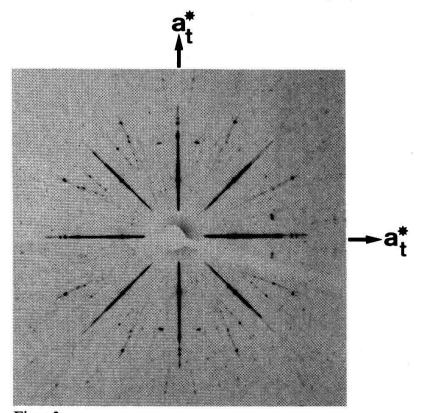
Figur 3 Präzessions-Orientierungsaufnahme. Primärstrahl senkrecht zur Ebene  $a_t a_t$ . Verwendete Strahlung: Mo 40 kV.
