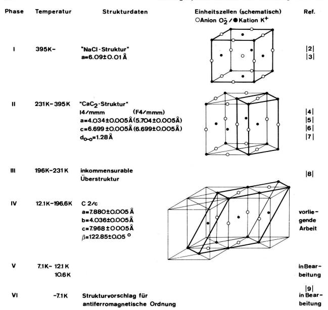
Figur 1 Uebersicht über die verschiedenen Phasen von KO<sub>2</sub>.
