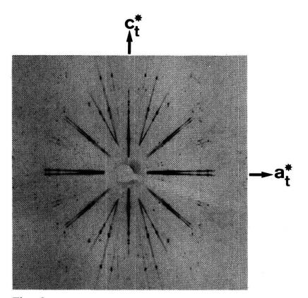
Figur 2 Präzessions-Orientierungsaufnahme. Primärstrahl senkrecht zur Ebene  $a_t c_t$ . Verwendete Strahlung: Mo 40 kV.
