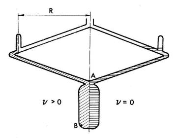
Figur 1 Rotationskammer. Die linke Hälfte zeigt das Flüssigkeitsniveau der drehenden, die rechte Hälfte dasjenige der ruhenden Kammer. Für ein festes dE/dx ist die Kammer bei hochdrehender Drehzahl zuerst in A, zuletzt in B nachweisempfindlich.
