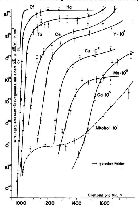
Figur 2 Integraler Wirkungsquerschnitt des dE/dx der Fragmente von Hg, Ta, Ce, Y, Cu, Mn und Ca gemessen mit 700 MeV Alphas. Die Kurven für Y, Cu, Mn und Ca sind um die angegebenen Dekaden nach unten, diejenige für Alkohol ist nach oben verschoben.
