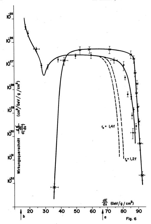
Figur 6 dE/dx-Spektren der Hg-Fragmente gemessen mit 21 GeV Neutronen ( $\bullet$ ) und 700 MeV Alphas ( $\times$ ). ----- erwartet, falls auf den Targetkern kein Impuls übertragen wird für  $r_0 = 1,4$ , resp. 1,2 Fermi. Das maximale dE/dx des Targetkerns beträgt ~132 GeV/g/cm². a) dE/dx des Targetkerns bei einem total elastischen Impulsübertrag des Alpha (~67 GeV/g/cm²). b) dE/dx des Targetkerns bei einem total inelastischen Impulsübertrag des Alpha (~14 GeV/g/cm²).
