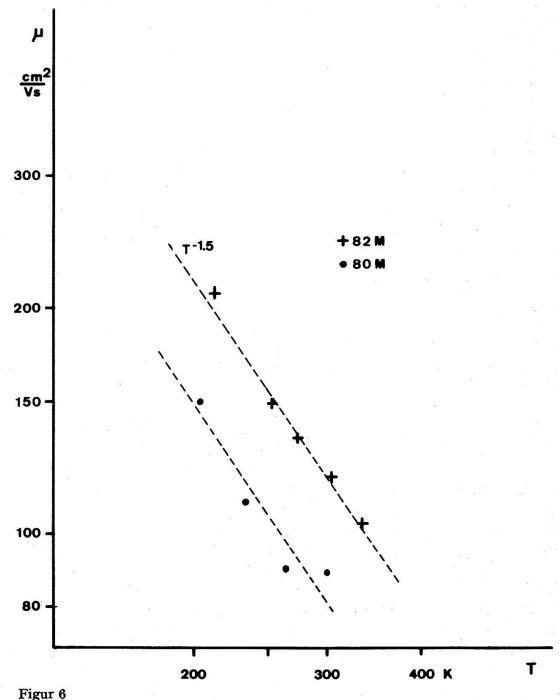
Die Beweglichkeit von Löchern in GaSe parallel zur c-Achse als Funktion der Temperatur. Messungen mit  $\alpha$ -Teilchen bei einer Driftfeldstärke von  $E_D = 2.5 \text{ kV/cm}$ .
