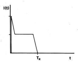
Figur 3 Schematischer Verlauf des Driftstroms, wenn die Eindringtiefe R der ionisierenden Strahlung gegenüber der Probendicke d nicht vernachlässigbar ist.
