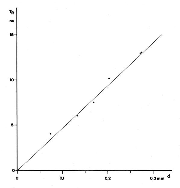
Figur 9 Die Transitzeit  $T_R$  als Funktion der Probendicke d bei konstanter Feldstärke  $E_D=10$  kV/cm. Die Gerade entspricht einer Löcherbeweglichkeit von  $\mu_{p\parallel}=210$  cm<sup>2</sup>/Vs bei T=300 K.
