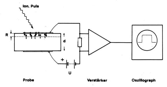
Figur 2 Schematische Darstellung des Driftexperiments. Die Probe besteht aus einem planparallelen Kristallplättchen mit zwei einander gegenüberliegenden Kontakten, wovon der eine für die ionisierende Strahlung durchlässig sein muss.
