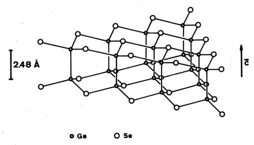
Figur 1 Die Struktur von GaSe. Die kleinen Kreise entsprechen den Galliumatomen.
