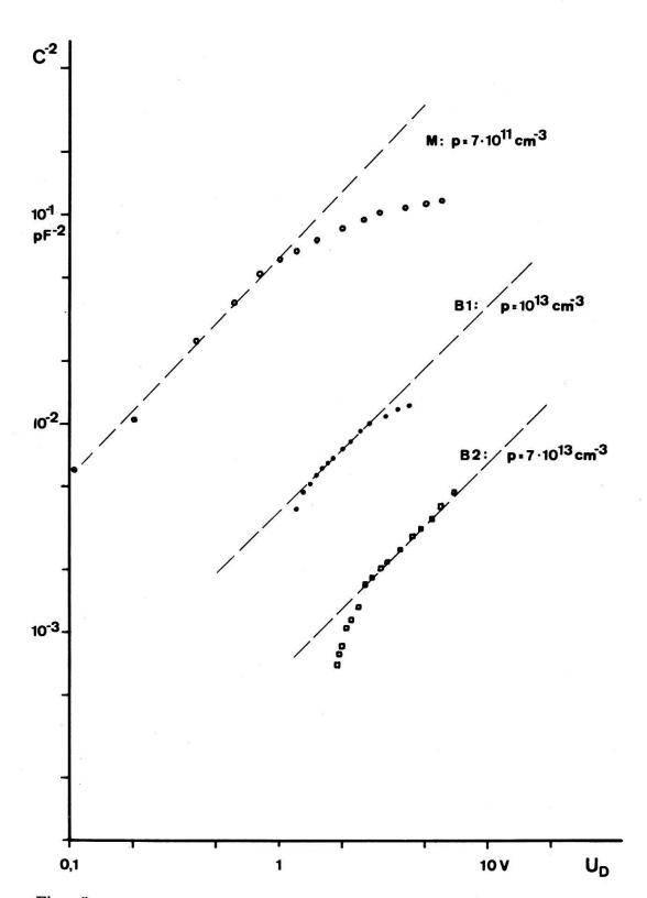
Figur 5 Die Bestimmung der Nettokonzentration der Ladungsträger aus Kapazitätsmessungen.  $1/C^2$  ist gegen  $U_D$  aufgetragen, wobei  $U_D-U_0+\phi$  gleich der Summe aus der angelegten Gleichspannung und der Diffusionsspannung ist.
