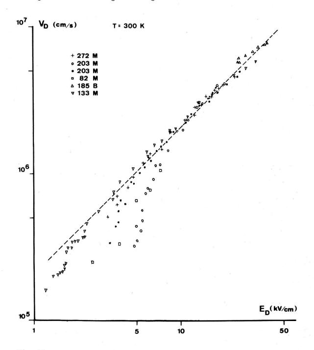
Figur 10 Die Driftgeschwindigkeit  $v_D$  als Funktion der Feldstärke  $E_D$  für sechs verschiedene Proben bei 300 K. Die gestrichelte Linie entspricht einer Beweglichkeit von  $\mu_{p\parallel}=210~{\rm cm^2/Vs}$ .
