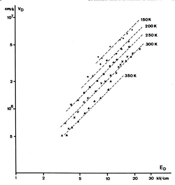
Figur 11 Die Driftgeschwindigkeit  $v_D$  als Funktion der Feldstärke  $E_D$  bei verschiedenen Temperaturen.
