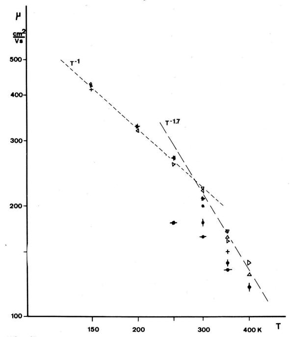
Figur 12 Die Löcherbeweglichkeit  $\mu_{p\parallel}$  als Funktion der Temperatur. Messungen mit dem Elektronenbeschleuniger bei  $E_D=10$  kV/cm. Bei höheren Temperaturen beträgt der Exponent der Temperaturabhängigkeit  $-1.7\pm0.2$ .
