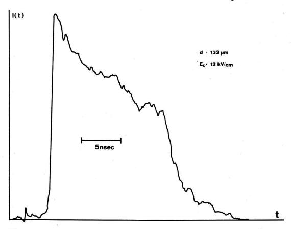
Figur 8 Driftstrom, ausgelöst durch einen Puls des Elektronenbeschleunigers.
