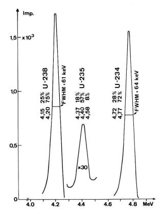
Figur 5  $\alpha$ -Spektrum von Uranylnitrat natürlicher Isotopenkonzentration, das im Vakuum bei 2000°C auf eine Aluminiumscheibe aufgedampft wurde. Messzeit  $4\frac{3}{4}$  Std.
