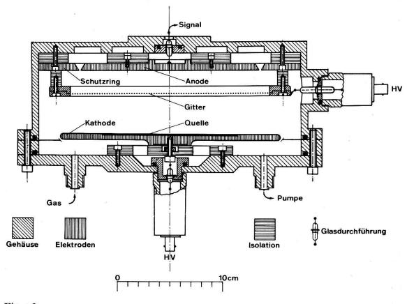
Figur 3 Skizze der Gitterionisationskammer.
