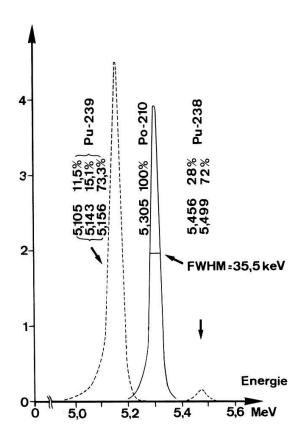
Figur 4 α-Spektrum von elektrolytisch abgeschiedenen Po-210 und Pu-239 Eichquellen. (Messzeit rund 2 min.)
