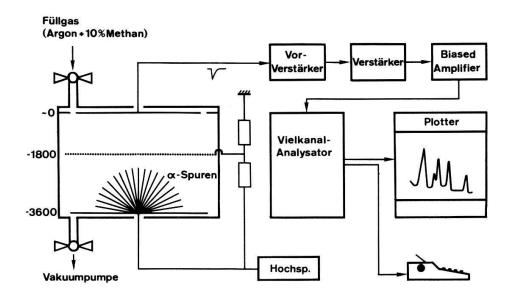
Figur 1 Blockschema der Messanlage.
