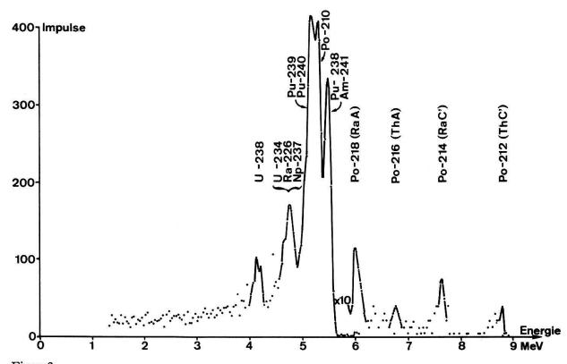
α-Spektrum einer Luftfilterprobe (ca. 1090 kg Luft) aus der oberen Troposphäre vom 18.5.1967. Die Filterasche wurde als Chloride in wässriger Lösung auf dem Quellenträger eingedampft. Messzeit 2 Tage.
