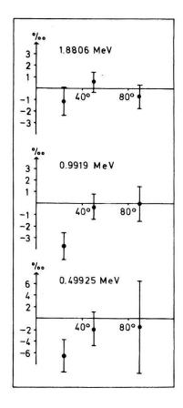
Figur 2 Abweichungen der gemessenen Wirkungsquerschnitte von den gerechneten in Promille:  $(\sigma_{\rm exp} - \sigma)/\sigma$ .
