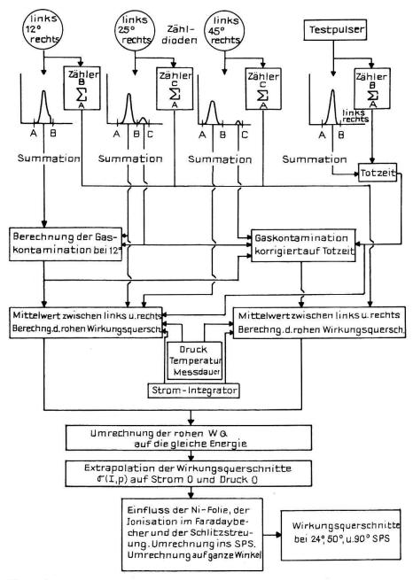
Figur 1 Flussdiagramm des Auswerteschemas.
