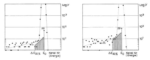
Figur 7 Energieverteilung koinzidenzfähiger Ereignisse, gewonnen durch Auswertung von Koinzidenzspektren. Energie 1881 keV; Druck 3 Torr. Die Spektren wurden mit zwei verschiedenen Spaltsystemen, die sich durch ihre Lamellendicken unterschieden, registriert. Die berechnete Spaltstreuung ist als Histogramm eingetragen.
