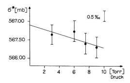
Figur 8 pp Wirkungsquerschnitt als Funktion des Kammerdruckes. Die gemessenen Wirkungsquerschnitte  $\sigma^*$  werden linear auf p=0 extrapoliert, woraus der korrigierte Wirkungsquerschnitt  $\sigma_0$  resultiert.  $\sigma^*$  sind Messwerte bei 1 MeV und 25 Grad, aufgenommen bei konstantem Strom. Die Werte sind noch nicht absolut geeicht.
