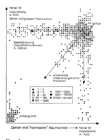
Figur 6 Ausschnitt aus einer 64 mal 64 Kanal Konturdarstellung von 2 MeV Protonen gestreut an 3 Torr  $\rm H_2$  unter 45° Grad im LS.
