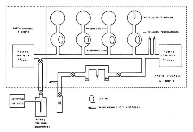
Figure 5 Système de préparation de cellule de verre à remplir avec He<sup>3</sup>.
