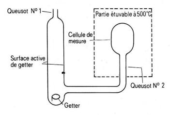
Figure 6 Cellule en préparation avec compartiment de purification.
