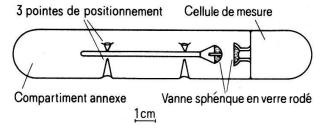
Figure 3 Croquis d'une cellule possédant une vanne intérieure.
