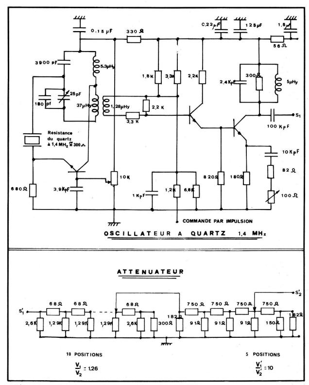
Figure 5 Oscillateur à quartz 1,4 MHz et atténuateur.
