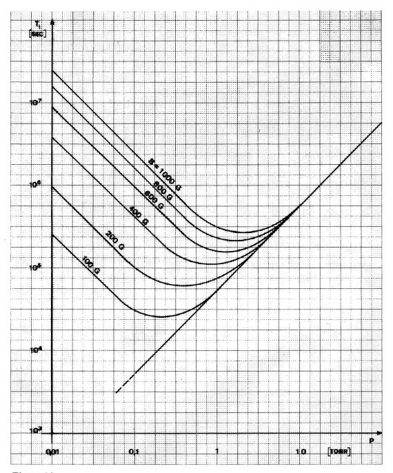
Figure 10 Temps de relaxation  $T_1$  en fonction de la pression et du champ magnétique dans le cas d'un gradient de champ de valeur relative constante de  $10^{-4}$ cm<sup>-1</sup>.
