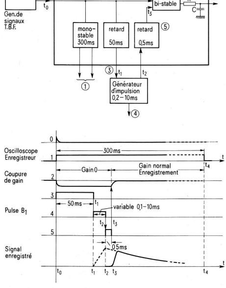
Figure 7 Organe de synchronisation et diagramme horaire de la mesure.
