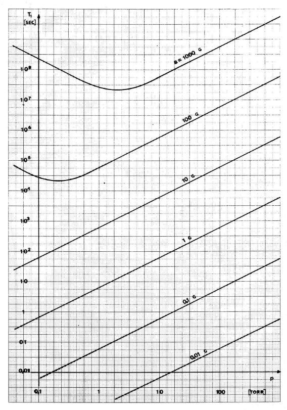
Figure 9 Temps de relaxation  $T_1$  en fonction de la pression et du champ magnétique pour le cas d'un gradient de champ de valeur fixe de  $10~{\rm mG/cm}$ .
