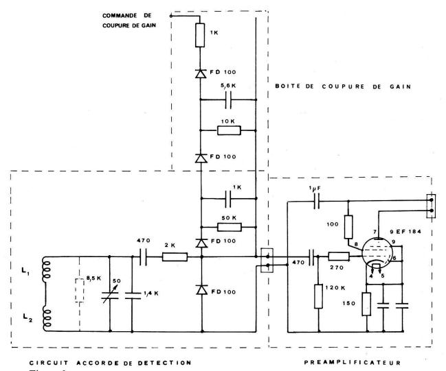
Figure 6 Schéma de commande du gain au premier étage de réception.
