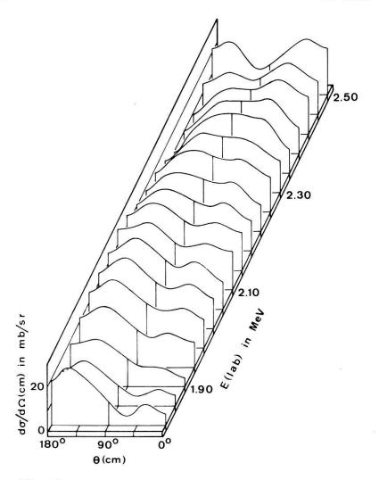
Figur 2  $^{12}{\rm C}(d,p_0)^{13}{\rm C}$  Winkelverteilungen. Die Kurven sind Legendre-Polynomanpassungen an die Messpunkte.
