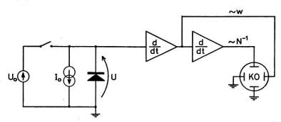
Figur 2 Prinzipielle Anordnung zur Dotierungsprofil-Messung nach [5].
