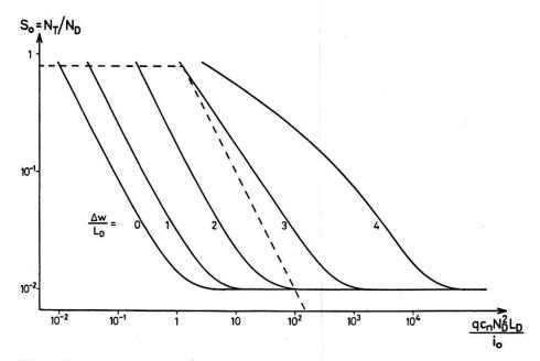
Figur 4 Die Messbedingung für S=0.01. Für ein vorgegebenes  $\Delta w$  erfüllt das Gebiet unter der entsprechenden Kurve die Bedingung S<0.01 (---- Näherung für  $\Delta w=3L_p$ ).
