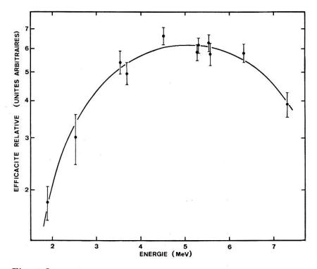
Figure 8 Courbe d'efficacité relative du spectromètre à paires.
