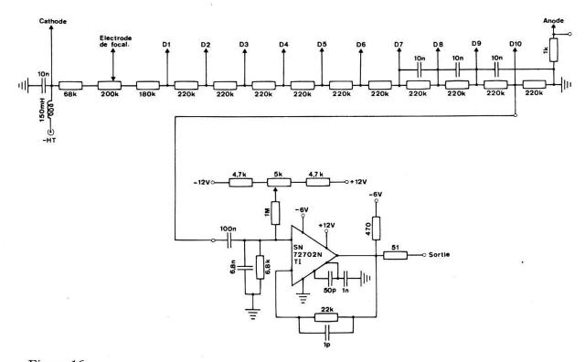
Figure 16 Schéma du diviseur de tension et du préamplificateur associés à chaque photomultiplicateur.
