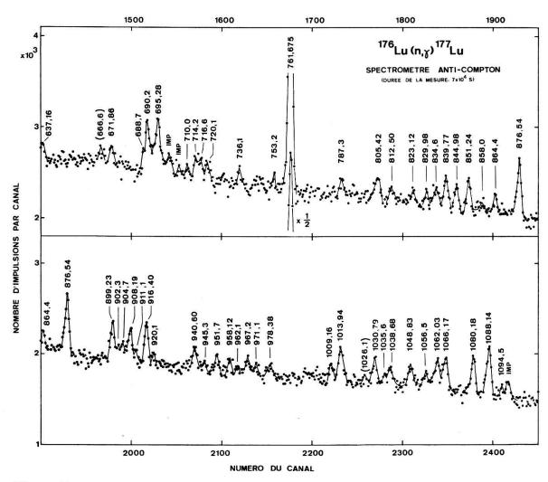
Figure 10 Portion du spectre  $\gamma$  de basse énergie de la réaction  $^{176}$ Lu $(n, \gamma)$  mesuré avec le spectromètre anti-Compton. L'énergie des transitions douteuses est indiquée entre parenthèses. Les impuretés sont dénotées par IMP.
