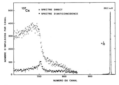
Figure 5 Portion du spectre  $\gamma$  direct et du spectre  $\gamma$  d'anticoïncidence du  $^{137}\mathrm{Cs}.$
