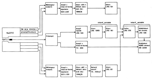
Figure 2 Schéma de principe du spectromètre à paires.
