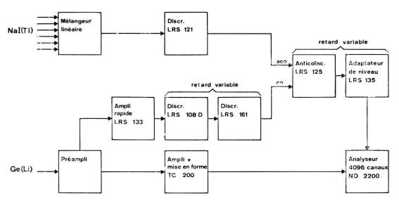
Figure 4 Schéma de principe du spectromètre anti-Compton.
