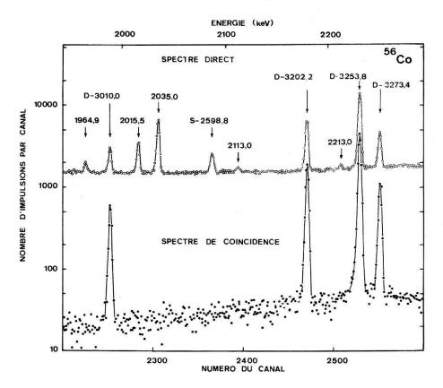
Figure 3 Portion du spectre  $\gamma$  direct et du spectre  $\gamma$  de coïncidence du  $^{56}$ Co. S dénote le pic d'échappement simple, D celui de double échappement.
