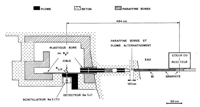
Figure 6 Coupe horizontale du dispositif expérimental pour l'étude des réactions  $(n, \gamma)$ .
