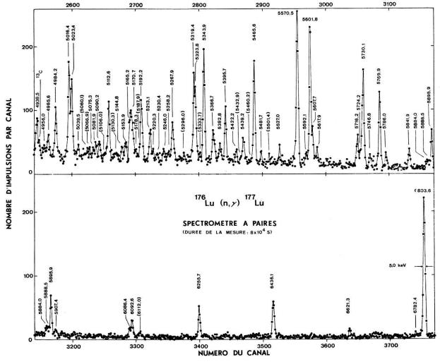
Figure 7 Spectre  $\gamma$  de haute énergie de la réaction  $^{176}$ Lu $(n, \gamma)$ , mesuré avec le spectromètre à paires. L'énergie des transitions douteuses est indiquée entre parenthèses.
