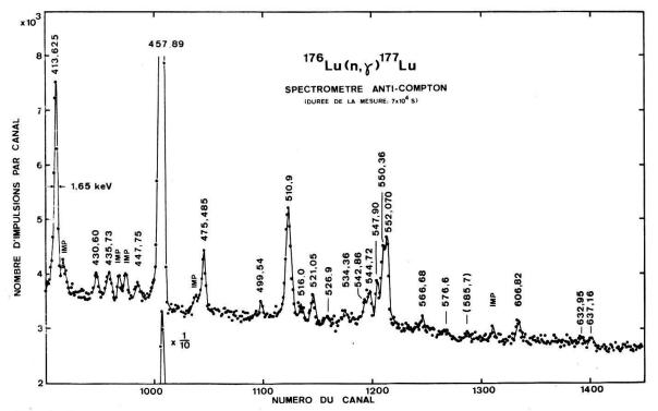
Figure 9 Portion du spectre  $\gamma$  de basse énergie de la réaction  $^{176}$ Lu $(n, \gamma)$  mesuré avec le spectromètre anti-Compton. L'énergie des transitions douteuses est indiquée entre parenthèses. Les impuretés sont dénotées par IMP.
