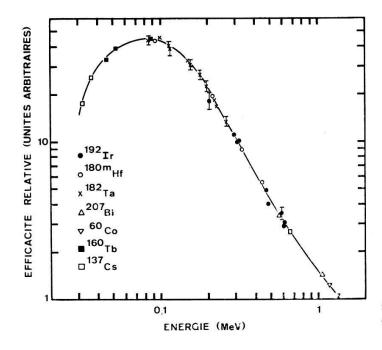
Figure 11 Courbe d'efficacité relative du spectromètre anti-Compton.
