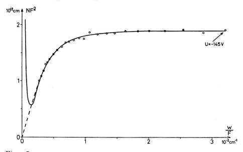
Figur 5 Dotierungsprofil einer Diode 1 N 4722.
