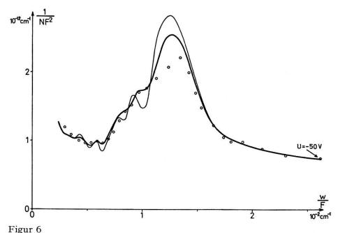
Reziprokes «Dotierungsprofil» einer vermutlich beschädigten Diode ZD 100. Dünne Linie: obere Grenzfrequenz der Differenzierschaltung 400 kHz. Dicke Linie: Grenzfrequenz 130 kHz. Punkte: aus Kapazitätsmessungen bestimmt,
