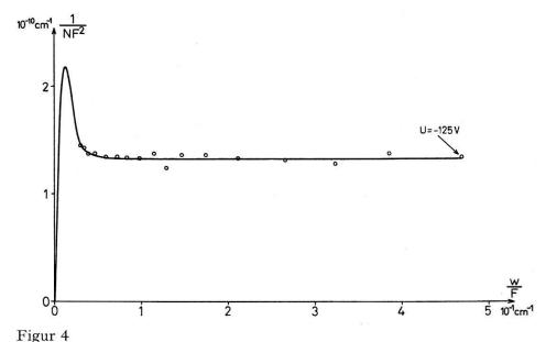
Reziprokes Dotierungsprofil einer Diode OA 210.
