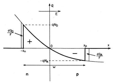
Figur 2 Nettodotierungsprofil und idealisierte Raumladung.
