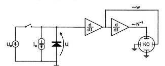
Figur 1 Prinzipielle Anordnung zur Dotierungsprofil-Messung.
