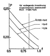
Figur 7 Abhängigkeit der Beziehung zwischen Polarisation Pund Absorptionssignal von der relativen spektralen Ausleuchtung f.
