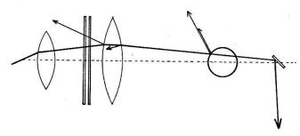
Figur 8 Strahlengang des Pump-und Messlichtes
