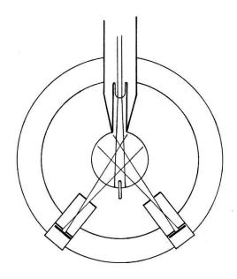
Figur 6 Schematische Darstellung der Zählergeometrie. Zusätzliche Zähler sind in der Ebene senkrecht zur Zeichenebene angebracht.
