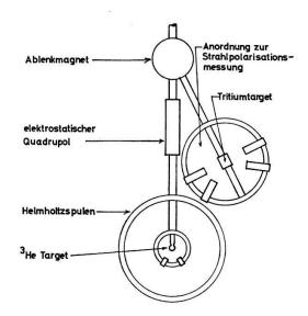
Figur 9 Aufbau des polarisierten <sup>3</sup>He-Targets und der Anordnung zur Messung der Strahlpolarisation am Beschleuniger.
