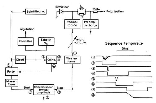
Figure 5 Circuit de temps de vol et séquence temporelle correspondante.
