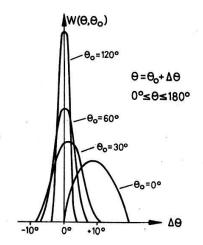
Figure 6 Fonction d'ouverture du télescope, calculée par Monte-Carlo pour différentes positions du télescope. Le calcul est purement géométrique et suppose une source de neutrons ponctuelle et isotrope (voir fig. 14).
