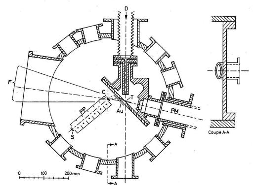
Figure 2 Chambre à réaction vue en coupe, avec le télescope en place. Au feuille d'or; C cible étudiée; D faisceau de deutons; F ouverture horizontale du faisceau de neutrons; PM logement du détecteur  $^4$ He; PP compteurs proportionnels; S semicteur; T cible tritiée.
