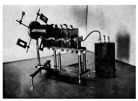
Figure 3 Vue du télescope. De droite à gauche: le préamplificateur rapide, le semicteur, les compteurs proportionnels et le carrousel de cibles.
