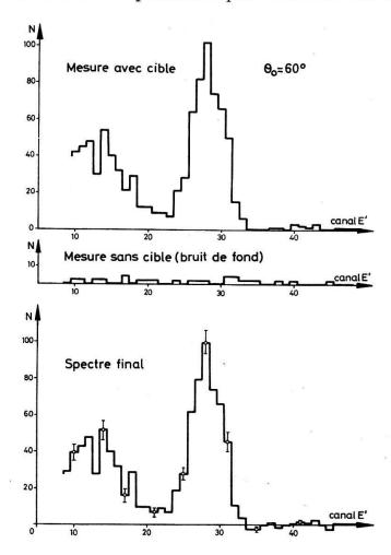
Figure 11 Spectre d'énergie restante pour  $^{12}$ C $(n, \alpha)$ à  $\theta_0 = 60^{\circ}$ . Cible de 1,2 mg/cm<sup>2</sup>.
