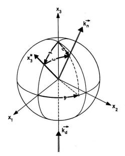
Figur 3 Koordinatensystem zur Beschreibung von Strahlpolarisation und Reaktion.
