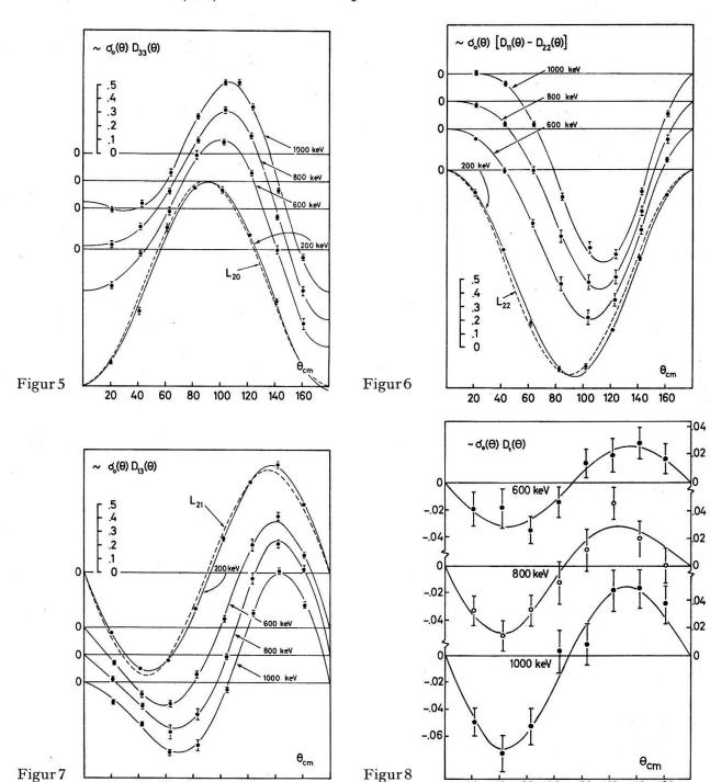
Figuren 5–8 Analysatorvermögen der  $T(\overrightarrow{d},n)^4$ He-Reaktion für die Vektor- und Tensorkomponenten  $P_1$ ,  $P_{33}$ ,  $P_{13}$  und  $P_{11}$ – $P_{22}$  der Deuteronenpolarisation. Die gestrichelt eingezeichneten Kurven entsprechen dem Verlauf für einen reinen 3/2+-Zustand, gebildet durch s-Wellen-Deuteronen. Die ausgezogenen Kurven sind Anpassungen mit den entsprechenden Legendre-Polynomen.
