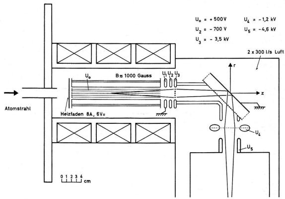
Figur 2 Ionisator und elektrostatischer Spiegel.
