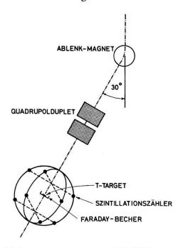
Figur 4 Schematische Darstellung der Messanordnung.
