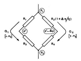
Figur 4 Viskositätsmessbrücke.
