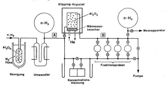
Figur 6 Apparatur zur Darstellung von Orthowasserstoff.
