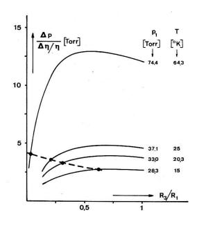
Figur 5 Variation der Brückenempfindlichkeit mit dem Kapillarwiderstandsverhältnis  $R_3/R_1$  bei konstantem Brückenausgangsdruck  $p_2=17,2$  Torr für div. Eingangsdrucke  $p_1$ . Die  $p_1$  zugeordneten Temperaturen T entsprechen Figur 3.
