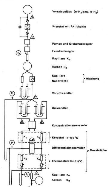
Figur 1 Schema der Apparatur zur Messung von relativen Viskositätsunterschieden.
