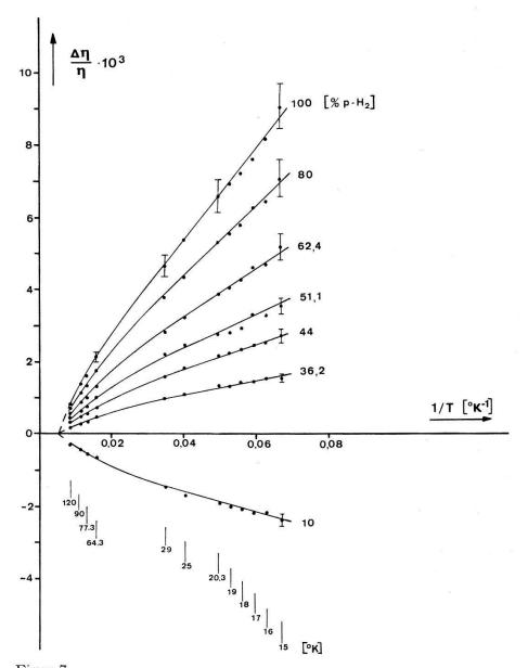
Figur 7 Messwerte für  $\Delta \eta/\eta \equiv (\eta(\gamma) - \eta(0.25))/\eta(0.25)$  in Funktion der reziproken Temperatur für div. p-H<sub>2</sub>-Molenbrüche. Die eingetragenen Kurven sind den Messpunkten optimal angepasst.
