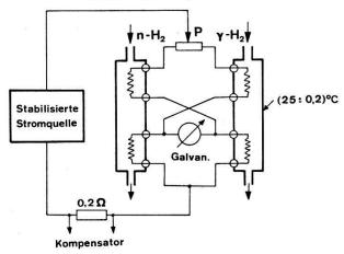
Figur 2 Wärmeleitfähigkeitsmessung zur Bestimmung der Modifikationskonzentrationen.
