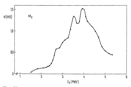
Figur 11 Integraler Wirkungsquerschnitt (integriert von  $\vartheta = 90^\circ$  bis  $\vartheta = 155^\circ$ ) der Reaktion  $^{13}$ C( $\tau$ ,  $\alpha_0$ ) $^{12}$ C. Die Messpunkte sind mit Kreisen markiert, deren Grösse dem statistischen Fehler entspricht.
