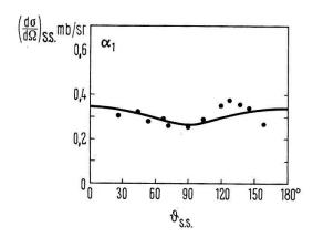
Figur 15 Die mit Kreisen markierten Messpunkte sind die im Energieintervall  $E_{\tau} = 2.1$  bis 2,86 MeV gemittelten Wirkungsquerschnitte für die Reaktion  $^{13}$ C $(\tau, \alpha_1)^{12}$ C. Die Grösse der Kreise entspricht dem statistischen Fehler. Die Kurve zeigt die Anpassung mit Hauser-Feshbach-Rechnung.
