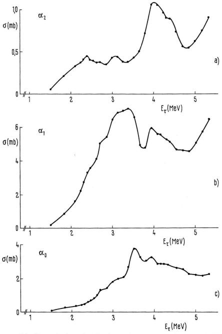
Figur 10 Integraler Wirkungsquerschnitt der Reaktionen  $^{13}$ C $(\tau; \alpha_{0,1,2})^{12}$ C. Die Messpunkte sind mit Kreisen markiert. Die Grösse der Kreise entspricht dem statistischen Fehler.
