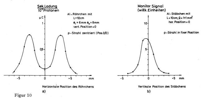
a) Die auf einem Röhrchen vom Protonenstrahl erzeugte Sekundäremissionsladung.
