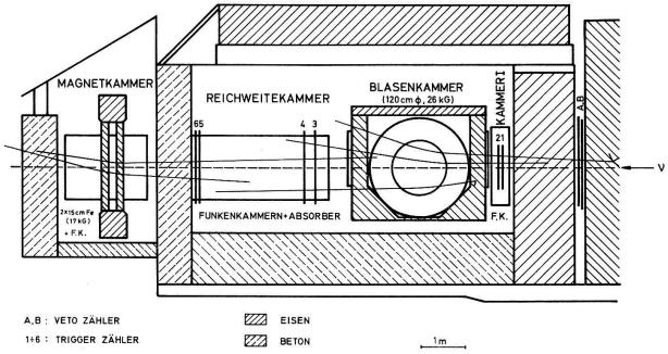
Figur 2 Anordnung der Detektoren (mit fünf typischen Myonspuren).
