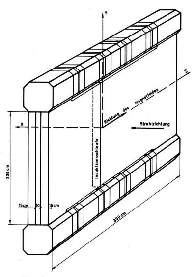
Figur 3 Ansicht der magnetisierten Eisenplatten.
