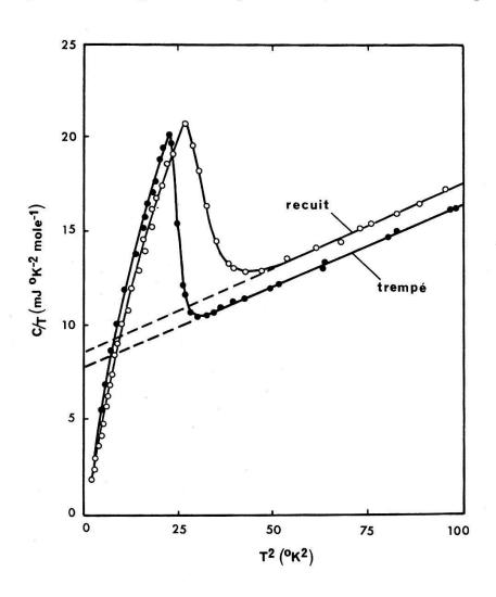
Figure 2 Chaleur spécifique C(T) de  $\mathrm{Ti}_{.75}\mathrm{Sb}_{.25}$  avant et après le recuit.
