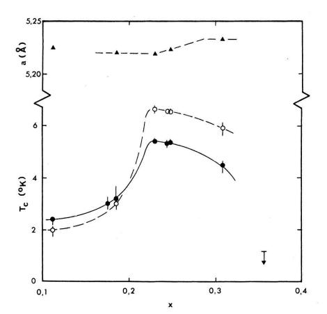
Figure 1 Température de transition  $T_c$  ( $\phi$  trempé,  $\phi$  recuit) et constante réticulaire a ( $\Delta$ ) de la phase A15 dans le binaire  $Ti_{1-x}Sb_x$ .
