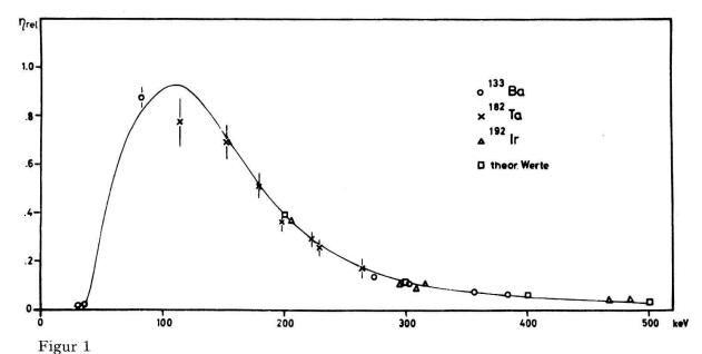
Relative Ansprechwahrscheinlichkeit  $\eta_{rel}$  der Diode in Funktion der  $\gamma$ -Energie. Die ausgezogene Linie stellt die an die Messwerte angepasste Hilfsfunktion  $\eta(E)$  dar.
