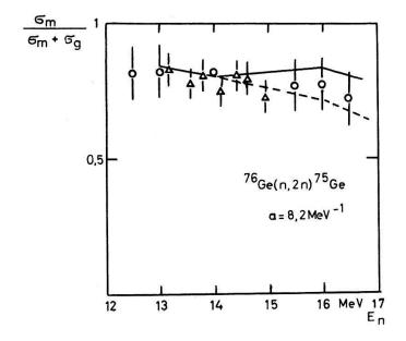
Figur 12 Isomerquerschnittsverhältnis der Reaktion  $^{76}$ Ge $(n, 2n)^{75}$ Ge $^{m, g}$  als Funktion der Neutronen-Energie. Die Kreise zeigen die Verhältnisse der Isomerquerschnitte  $\sigma_m$  nach Bormann et al. [26] und unserer totalen (n, 2n)-Querschnitte (metastabil + Grundzustand). Die Dreiecke repräsentieren experimentelle Ergebnisse von Okumura [25]. Die ausgezogene Kurve wurde nach dem Fermigas-Modell, die gestrichelte nach dem Supraleiter-Modell berechnet.
