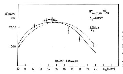
Figur 8c (n, 2n)-Wirkungsquerschnitt von <sup>197</sup>Au als Funktion der Neutronen-Energie. Vergleich von theoretischen und experimentellen [10] Werten. Die ausgezogene Kurve wurde mit einem Niveaudichte-Parameter nach Newton berechnet  $(a = 14,4 \text{ MeV}^{-1})$ , die gestrichelte mit einem solchen nach Barr et al.  $(a = 9,5 \text{ MeV}^{-1})$ .
