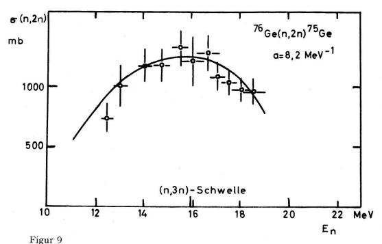
(n, 2n)-Querschnitt von <sup>76</sup>Ge als Funktion der Neutronen-Energie. Die offenen Kreise sind die Ergebnisse unserer Messungen. Die ausgezogene Kurve gibt das Resultat unserer Berechnung im Rahmen des statistischen Modells. Die Anpassung erfolgte mit  $\sigma_{n,M}/\sigma_a = 0.85$  (siehe S. 29/30). Der Niveaudichte-Parameter a = 8.2 wurde mit Hilfe der Beziehung von Newton [18] berechnet:
