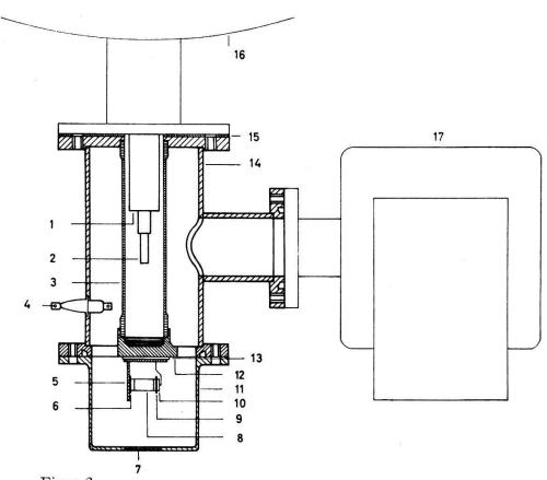
Figur 2 Kryostat mit Ge-pin-Diode und Getterpumpe
