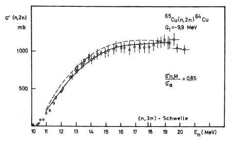
Figur 8a (n, 2n)-Wirkungsquerschnitt von 65Cu als Funktion der Neutronen-Energie. Vergleich von experimentellen Daten [10] mit theoretischen Werten. Die ausgezogene Kurve basiert auf einem nach Newton berechneten Niveaudichte-Parameter ( $a = 5.6 \text{ MeV}^{-1}$ ), die gestrichelte Kurve auf einem solchen nach Barr et al.  $(a = 6.9 \text{ MeV}^{-1})$ .
