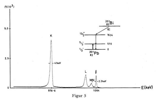
Gamma- und Konversionselektronenspektrum des 1064 keV- $^{207}_{82}$ Pb-Übergangs.  $U_s=+6$  kV,  $U_d=800$  V.
