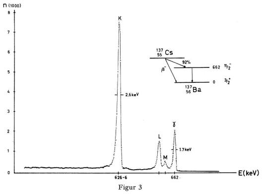
Gamma- und Konversionselektronenspektrum des 662 keV- $^{137}_{56}$ Ba-Übergangs. Vorspannung der Quelle  $U_s=+6$  kV, Betriebsspannung der Diode  $U_d=1400$  V.
