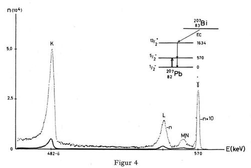
Gamma- und Konversionselektronenspektrum des 570 keV- $^{207}_{82}$ Pb-Übergangs.  $U_s=+6$  kV,  $U_d=800$  V.
