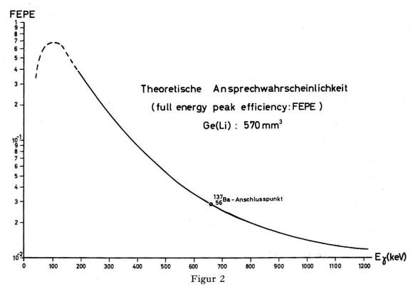
Berechnete und angeschlossene Ansprechwahrscheinlichkeit der Diode für Gammastrahlung (full energy peak efficiency).
