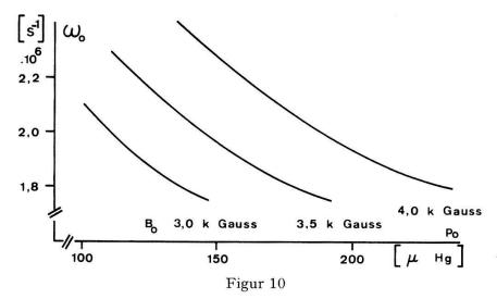
Nullstellen der Funktion  $I_1$  (2  $\omega$ , 2 k, k  $r_1$ ).
