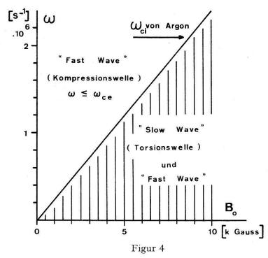
Existenzbereich der hydromagnetischen Wellen.
