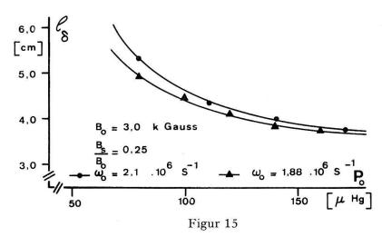
Experimentell bestimmte Dämpfungslänge in Abhängigkeit vom Gasdruck.
