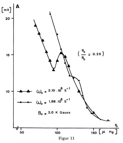
Verschiebung der Resonanzstelle mit der Frequenz.
