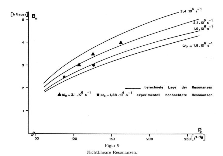
Magnetfeld und Frequenz sind dabei Parameter, während der Fülldruck des Gases in Schritten von etwa 5  $\mu$  Hg variiert.
