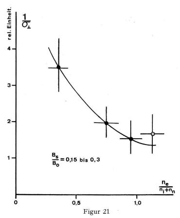
Aus Dämpfung und Phasengeschwindigkeit bestimmter spez. Widerstands eines Argonplasmas bei Teilionisation.
