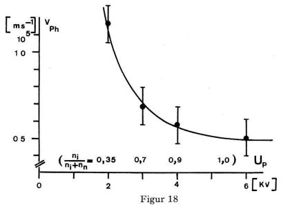
Gemessene Phasengeschwindigkeiten in Abhängigkeit von der Ladespannung.
