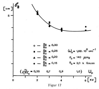
Experimentell bestimmte Dämpfungslänge in Abhängigkeit von der Ladespannung.
