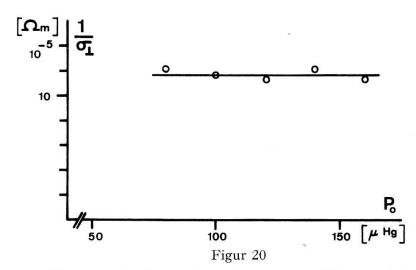
Aus Dämpfung und Phasengeschwindigkeit bestimmter spez. Widerstand des Plasmas in Funktion des Druckes.
