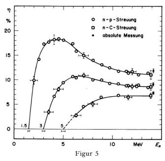
Ansprechwahrscheinlichkeit  $\eta(E, E_S)$  des Neutronendetektors für die Schwellenenergien  $E_S=5$ , 3 und 1,5 MeV  $(E\equiv E_n)$ .
