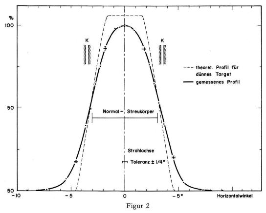
Horizontalprofil des koinzidenten Neutronenstrahls. K: Kontrollschlitze zur Überwachung der Strahlachsenlage.
