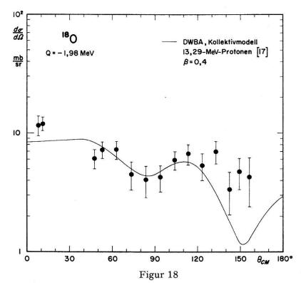
Inelastischer differentieller Streuguerschnitt für <sup>18</sup>O, Q = -1.98 MeV.
