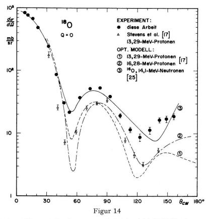
Elastischer differentieller Streuquerschnitt für 14,1-MeV-Neutronen an <sup>18</sup>O.
