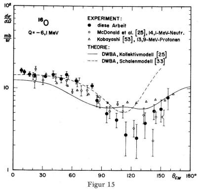
Inelastischer differentieller Streuquerschnitt für  $^{16}$ O, Q=-6.1 MeV.
