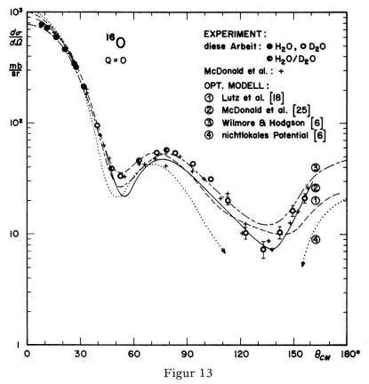
Elastischer differentieller Streuquerschnitt für 14,1-MeV-Neutronen an <sup>16</sup>O.
