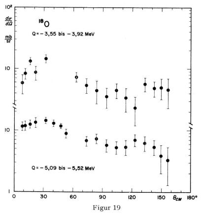
Inelastische differentielle Streuquerschnitte für <sup>18</sup>O, Q=-3,55 bis -3,91 MeV und Q=-5,09 bis -5,52 MeV.
