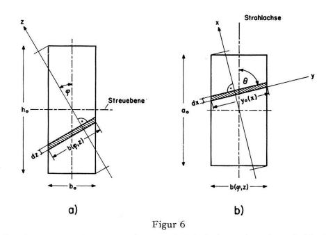
Zur Berechnung der Absorptions- und Mehrfachstreukorrektur (s. Text).
