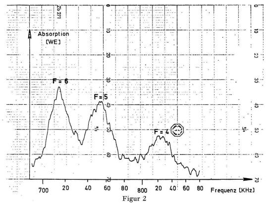
Drei Resonanzen (F=6.5 und 4) des  $^8\mathrm{S}_{7/2}$  Grundzustands von Eu bei  $H_0=437$  mOe. Der Frequenzbereich von 700 bis 880 kHz wurde in 13 Minuten überstrichen. Absorption in willkürlichen Einheiten (WE).
