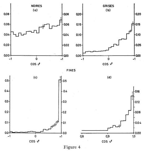
Distributions angulaires des traces noires (a), grises (b) et fines (c) avec le détail du pic vers l'avant (d) pour les traces fines.
