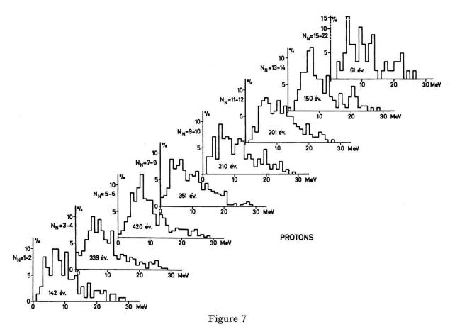
Spectres énergétiques des protons pour différentes catégories d'étoiles.
