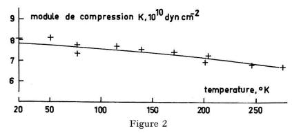
Module de compression de la Na en fonction de température selon les mesures de Beecroft et Swenson [17, 18] et calculé à l'aide de la formule (22) avec K (293°K) = 6,71·10<sup>10</sup> dyn cm<sup>-2</sup> et  $(V_0 - \varepsilon)/V_0 = 0,614$ .
