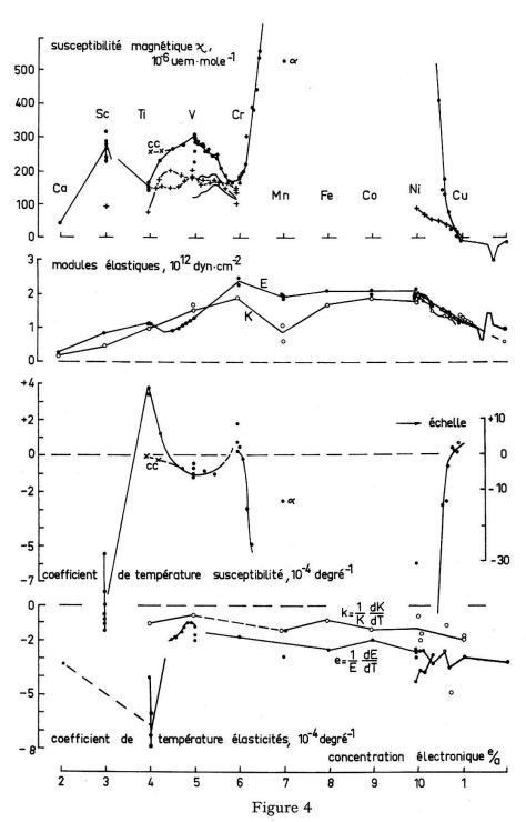
Susceptibilités magnétiques et modules élastiques et leurs coefficients de température des éléments et alliages de la période 4.
