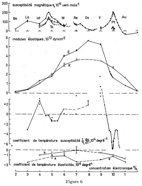
Susceptibilités magnétiques et modules élastiques et leurs coefficients de température des éléments et alliages de la période 6.
