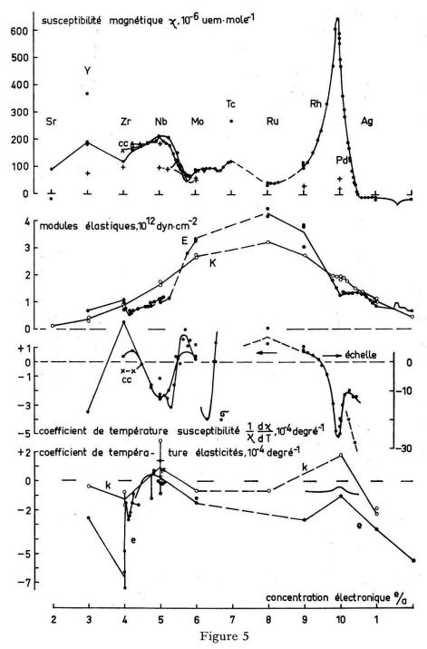
Susceptibilités magnétiques et modules élastiques et leurs coefficients de température des éléments et alliages de la période 5.
