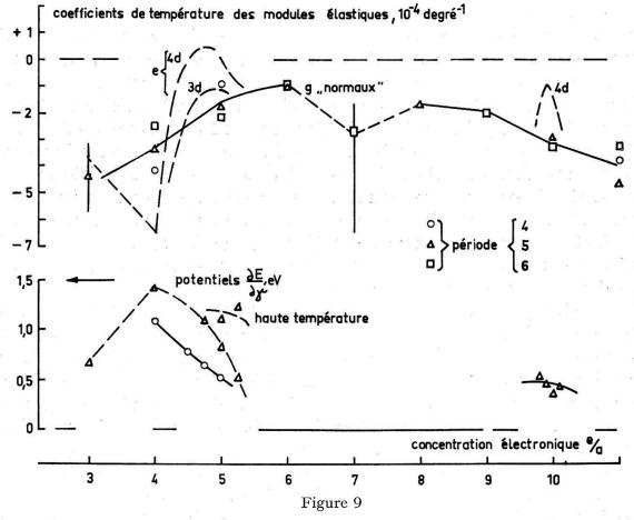
Coefficients de température des modules élastiques des alliages polycristallins et coefficients de température des modules de cisaillement «normaux» des monocristaux et les potentiels de déformation calculés à partir de la formule (35).
