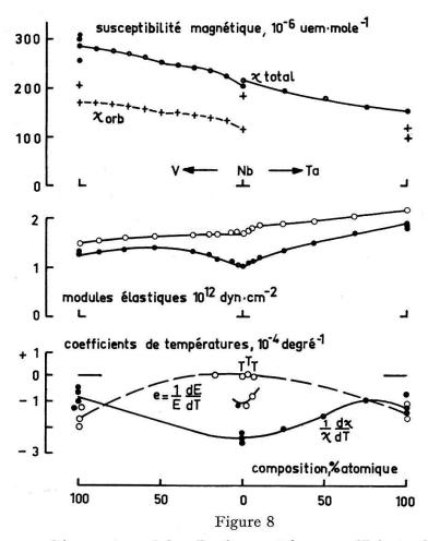
Susceptibilités magnétiques et modules élastiques et leurs coefficients de température pour la série isoélectronique V-Nb-Ta.
