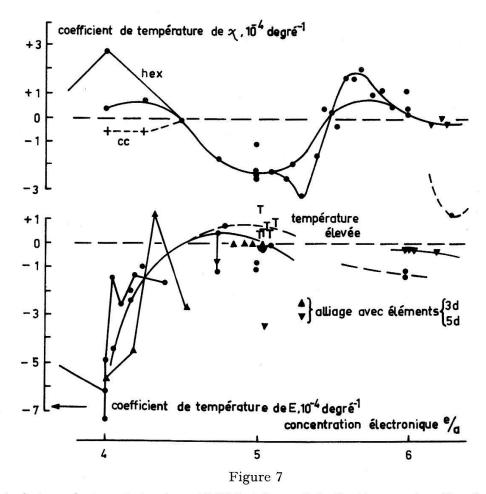
Coefficients de température de la susceptibilité et du module élastique en fonction de la concentration électronique e/a=4 à 6 pour les alliages à base d'éléments de la période 5.
