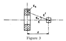
Les diffusions successives d'un neutron incident par un noyau D du scintillateur central, puis sur un noyau  ${}^1H$  du scintillateur annulaire définit un recul quasi central du deuton ( $\theta_n$  faible). L'énergie du deuton est alors utilisée comme mesure pour l'énergie du neutron incident. L'efficacité  $\eta$  du spectromètre dépend de l'énergie du neutron incident E, de la distance d entre scintillateur et du seuil de détection du scintillateur annulaire  $E_s$
