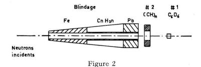
$1=\text{scintillateur liquide au benzène deutérisé, cylindrique } (C_6D_6)\\ 2=\text{scintillateur plastique de forme annulaire } (CH)_n; \text{ diamètre extérieur 14 cm}$
