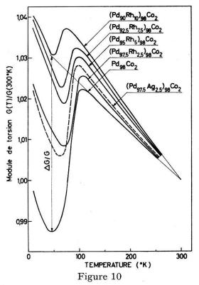
Variation relative du module de torsion avec la température des alliages contenant 2% de Co et exemple de détermination de la valeur  $\Delta G/G$  pour le  $\mathrm{Pd_{98}Co_2}$ .
