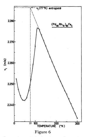
Comportement de la vitesse des ondes torsionnelles en fonction de la température pour l'alliage ( $Pd_{90}Rh_{10}$ )<sub>95</sub>Fe<sub>5</sub> et exemple d'extrapolation de l'écart des vitesses  $\Delta v_t = v_t \ (77 \, ^{\circ} \text{K}) - v_t \ (300 \, ^{\circ} \text{K}).$
