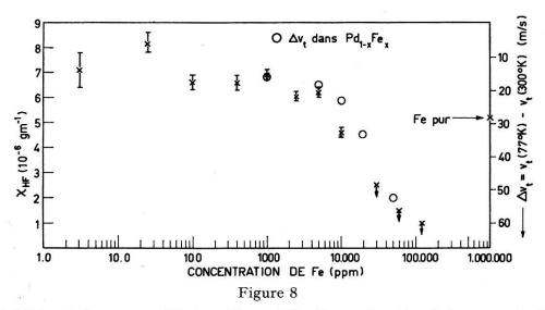
Susceptibilité à haut champ  $\chi_{HF}$  [3] des alliages  $Pd_{1-x}Fe_x$  en fonction de la concentration de Fe, comparée à l'écart des vitesses torsionnelles dans une échelle arbitraire.
