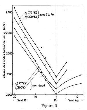
Vitesse des ondes torsionnelles pour la série d'alliages Pd-Rh et Pd-Ag sans impureté et avec 2% de Fe.
