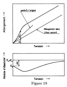
Diagramme de l'allongement et du module d'élasticité en fonction de la tension mécanique pour une substance ferromagnétique.
