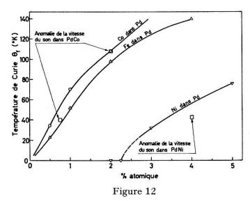
Températures de Curie mesurées dans le Pd en fonction de la concentration de Fe, Co, Ni [6] et températures des anomalies de la vitesse du son observées.
