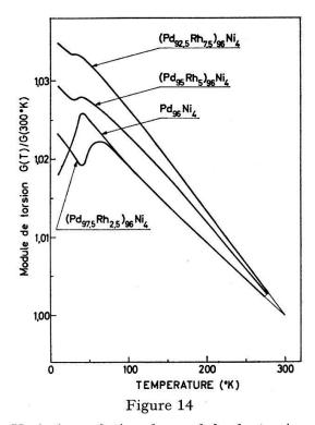
Variation relative du module de torsion avec la température des alliages contenant 4% de Ni pour différentes concentrations de Rh.
