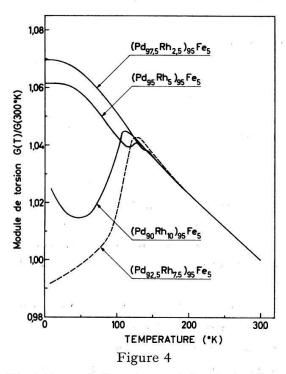
Variation relative du module de torsion avec la température des alliages contenant 5% de Fe pour différentes concentrations de Rh.
