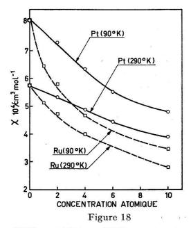
Susceptibilité magnétique d'alliages Pd-Pt et Pd-Ru en fonction de la concentration atomique [10 et 12].
