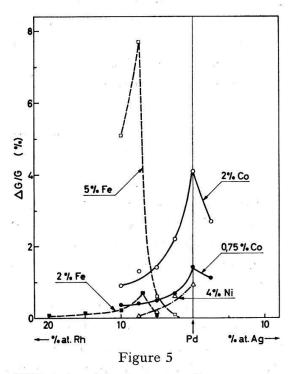
$\Delta G/G$ , intensités des anomalies apparaissant au point de Curie en fonction de la concentration de Rh et d'Ag pour diverses impuretés.
