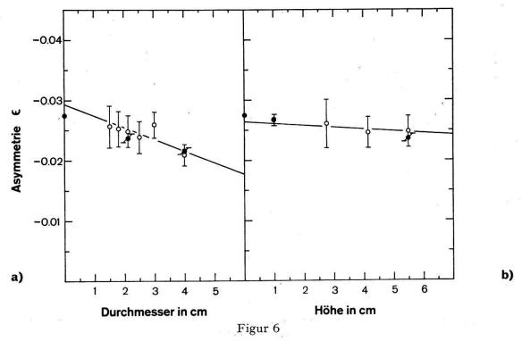
Asymmetrie von Cu für  $\theta=80^\circ$  in Funktion der Streukörperdimensionen. O gemessene Asymmetrien,  $\bullet$  gerechnete Asymmetrien, — beste Geraden durch die Messpunkte. a) Streukörperhöhe 5,5 cm, b) Streukörperdurchmesser 2 cm.
