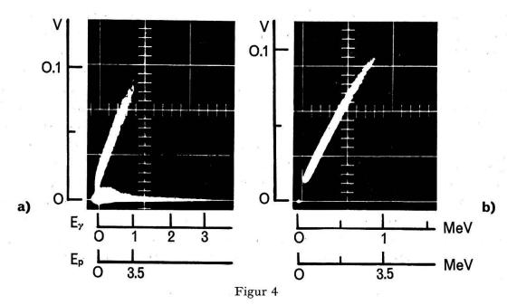
a und b: Höhe des Impulses, der durch Impulsformdiskrimination gewonnen wurde (Ordinate) in Funktion der Energie (Abszisse). Obere Linie zeigt Rückstossprotonen von maximal 3,5 MeV, untere Linie  $\gamma$ -Strahlen, die durch Neutroneneinfang im umgebenden Paraffin entstanden (negative Impulse sind unterdrückt).
