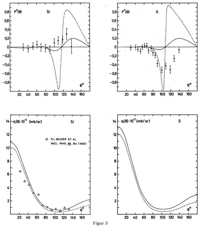
Analysatorvermögen und differentieller Querschnitt der Elemente Si und S
