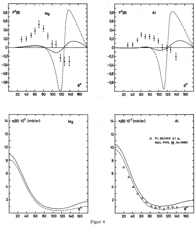
Analysatorvermögen und differentieller Querschnitt der Elemente Mg und Al
