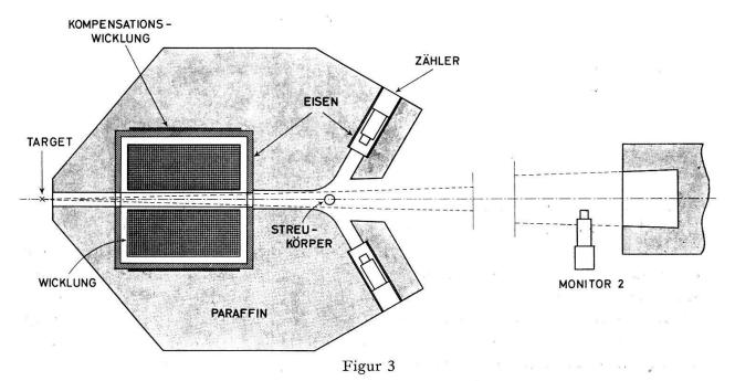
Versuchsanordnung im Horizontalschnitt
