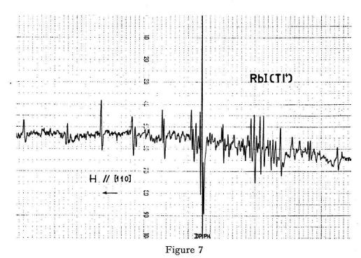
Spectre des centres  $V_K$  dans RbI(Tl<sup>+</sup>) après irradiation par rayons X (140 kV, 2 mA, 4 h) à 77 °K et mesuré à cette température avec H || [110].
