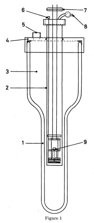
Dispositif de mesure et d'irradiation à T > 57 °K.
