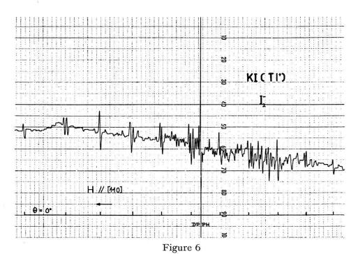
Spectre de  $I_2^-$  (centre  $V_K$ ) dans KI(Tl<sup>+</sup>) après irradiation X (140 kV, 2 mA, 3 h) à 77 °K et mesuré à cette température avec H || [110].
