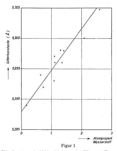
Gitterkonstante in Abhängigkeit von der Wasserstoffkonzentration.
