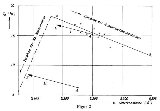
Sprungtemperatur in Abhängigkeit von der Gitterkonstante.
