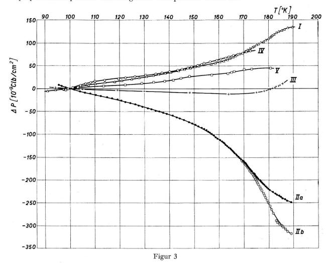
Unterschied der Polarisation gegenüber der unbekannten Polarisation bei 100°K. Aufgenommen mit dem Elektrometer (Figur 2) während Erwärmung (ca. 1°/min).
