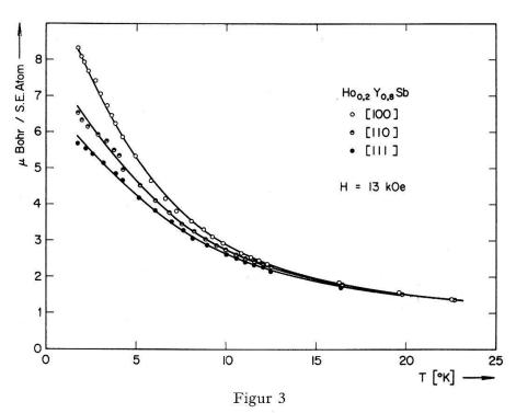
Magnetisches Moment pro Ho-Ion als Funktion der Richtung des angelegten Feldes und der Temperatur, gemessen bei 13 kOe an der Verbindung Ho<sub>0,2</sub>Y<sub>0,8</sub>Sb.
