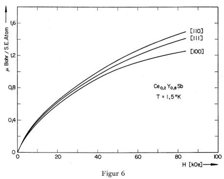
Magnetisches Moment pro Ce-Ion als Funktion der Grösse und Richtung eines äusseren Magnetfeldes gemessen an der Verbindung Ce<sub>0,2</sub>Y<sub>0,8</sub>Sb.
