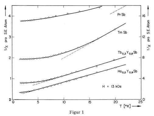
Inverse Suszeptibilitäten in cgs-Einheiten berechnet pro Mol der Seltenen Erde von PrSb, TmSb,  $\text{Ho}_{0,2}\text{Y}_{0,8}\text{Sb}$  und  $\text{Tb}_{0,2}\text{Y}_{0,8}\text{Sb}$  als Funktion der Temperatur. (Die Skala auf der rechten Seite gilt für PrSb.)
