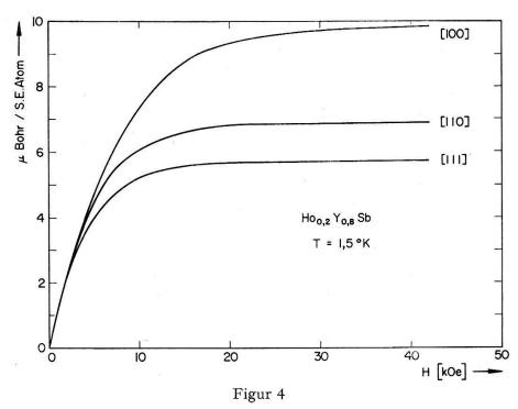
Magnetisches Moment pro Ho-Ion als Funktion der Grösse und Richtung eines äusseren Magnetfeldes gemessen an der Verbindung  $\mathrm{Ho_{0,2}Y_{0,8}Sb}$ .
