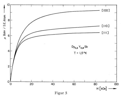
Magnetisches Moment pro Dy-Ion als Funktion der Grösse und Richtung eines äusseren Magnetfeldes gemessen an der Verbindung  $\mathrm{Dy_{0,2}Y_{0,8}Sb}$ .
