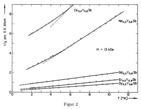
Inverse Suszeptibilitäten in cgs-Einheiten berechnet pro Mol der Seltenen Erde von  $Ce_{0,2}Y_{0,8}Sb$ ,  $Nd_{0,2}Y_{0,8}Sb$ ,  $Er_{0,2}Y_{0,8}Sb$ ,  $Dy_{0,2}Y_{0,8}Sb$  und  $Gd_{0,2}Y_{0,8}Sb$  als Funktion der Temperatur.
