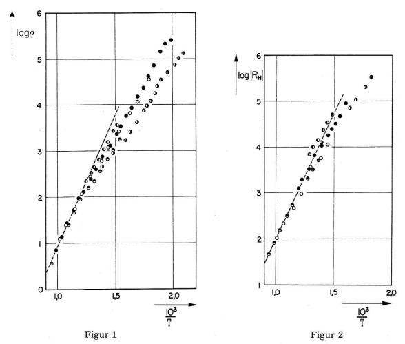
Spezifischer Widerstand von polykristallinen Proben des Magnesiumarsenids Mg<sub>3</sub>As<sub>2</sub>.
