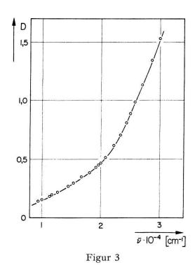
Absorptionsspektrum einer aufgedampften Schicht des Magnesiumarsenids.
