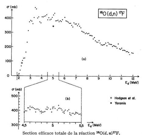
a) résolution d'énergie de 100 keV; b) résolution de 20 keV.
