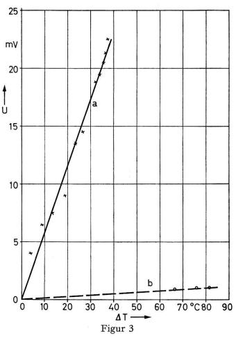
Thermospannung bei VO2-Einkristallen. a) unterhalb  $T_u$ , kalter Kontakt 20 °C, b) oberhalb  $T_u$ , kalter Kontakt 80 °C.
