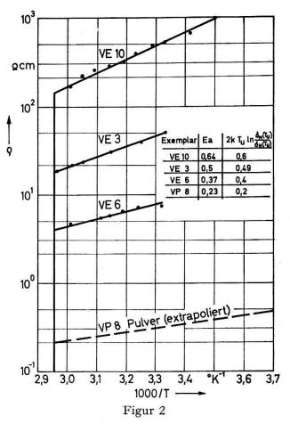
Widerstandstemperaturgang von VO<sub>2</sub>-Proben in der Nähe des Umwandlungspunktes. (Die Pulverprobe wurde auf gleichen spezifischen Widerstand im metallisch leitenden Zustand normiert.)
