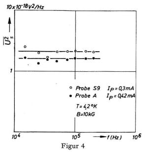
Frequenzabhängigkeit des mittleren Rauschspannungsquadrates pro Hz Bandbreite (Stromrauschen) für *n*-InSb bei 4,2°K.
