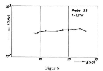
Magnetfeldabhängigkeit der Frequenz der Spannungsoszillationen für *n*-InSb Probe S9 bei 4,2 °K. Die Frequenz wurde jeweils im Einsatzpunkt der Oszillationen gemessen.
