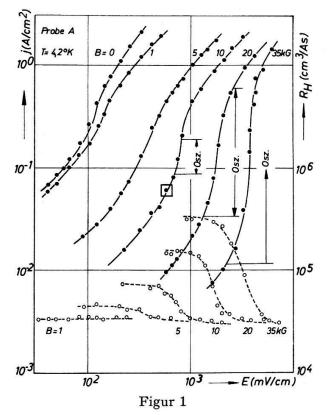
Abhängigkeit der Stromdichte und des Hall-Koeffizienten vom elektrischen Feld für *n*-InSb Probe A bei 4,2°K. Parameter: Transversale magnetische Induktion.
