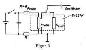
Prinzipschaltung zur Rauschmessung im Vergleichsverfahren.
