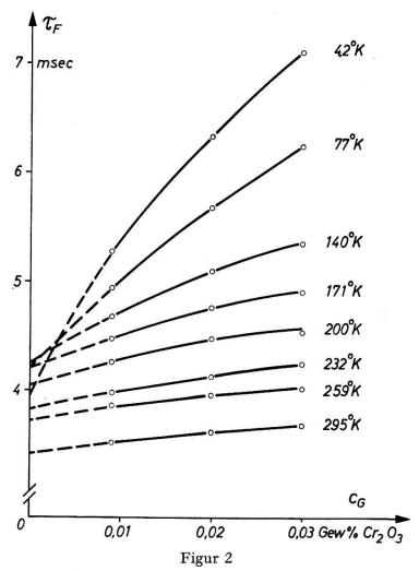
Die Fluoreszenzabklingzeit  $\tau_F$  der R-Linien von Kristallen der Form  $2.5 \times 2.5 \times 0.25$  mm³. Die Temperaturabhängigkeit der Kurven folgt hauptsächlich aus der thermischen Verbreiterung der R-Linien.
