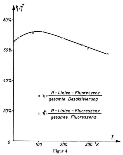
Quantenwirkungsgrad  $\eta$  für Emission in den R-Linien und das Verhältnis  $\eta^*$  [1] der R-Linien-fluoreszenz zur Gesamtfluoreszenz des Rubins als Funktion der Temperatur.
