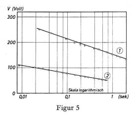
Prüfung des logarithmischen Zeitgesetzes an der Hellentladung in trockener Luft nach negativer Aufladung. 1) 60 Gewichts-% Siliconharz. 2) 10 Gewichts-% Siliconharz.
