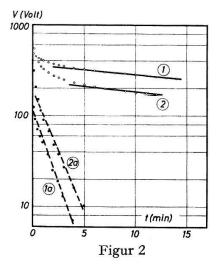
Zwei Beispiele für das Versagen des exponentiellen Zeitgesetzes  $V_0 \cdot \exp{(-t/\tau)}$ . Den Abweichungen wurde ein zweiter Term  $V_1 \cdot \exp{(-t/\tau_1)}$  angepasst (1a und 2a).
