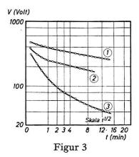
Prüfung der Formel von Inoue an einer Probe mit 60 Gewichtsprozent Siliconharz. 1) Positive Aufladung in trockenem Sauerstoff. 2) Negative Aufladung in trockener Luft. 3) Negative Aufladung in feuchter Luft. Wäre Inoues Zeitgesetz erfüllt, müssten sich Geraden ergeben.
