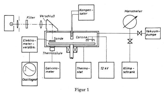
Schema der Versuchsanordnung.
