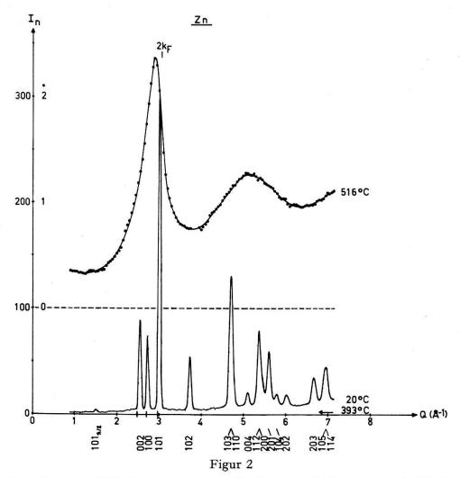
Vergleich der Neutronendiffraktogramme von flüssigem (516 °C) und polykristallinem (20 °C, 393 °C) Zink.  $Q = \text{Impulsübertrag} = (4 \pi/\lambda) \sin \theta$ ;  $2 \theta = \text{Streuwinkel}$ ; Wellenlänge  $\lambda = 0.90 \text{ Å}$ ;  $2 k_F = \text{Durchmesser}$  der Fermi-Kugel.
