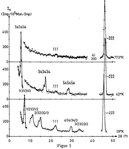
Neutronendiffraktogramme (Wellenlänge 1,39 Å) von einem EuSe-Einkristall ( $1 \times 1 \times 3$  mm³) in [111]-Richtungen bei verschiedenen Temperaturen und ohne äusseres Magnetfeld. Die Reflexe (1/41/4) und (1/31/31/3) wurden mit einem Kollimator gemessen.
