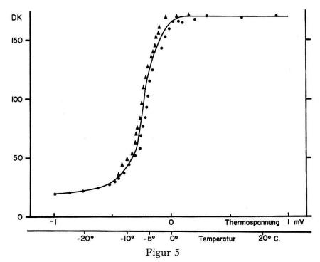
Temperaturabhängigkeit der DK von (ND<sub>4</sub>)<sub>2</sub>D<sub>3</sub>IO<sub>6</sub> nach [14] und [18]; die DK-Werte sind absolut nur von beschränkter Genauigkeit.
