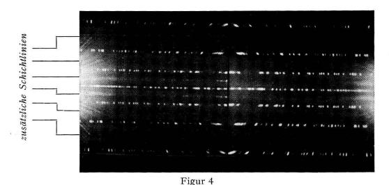
Drehkristall-Aufnahmen von  $(NH_4)_2H_3IO_6$  bei Drehung um die a-Achse. Rechts bei Zimmertemperatur, links in der antiferroelektrischen Phase (mit Überstruktur-Schichtlinien).
