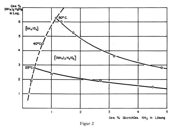
Löslichkeitsisothermen des Diammoniumsalzes bei 25° und 50°C (Bodenkörper).
