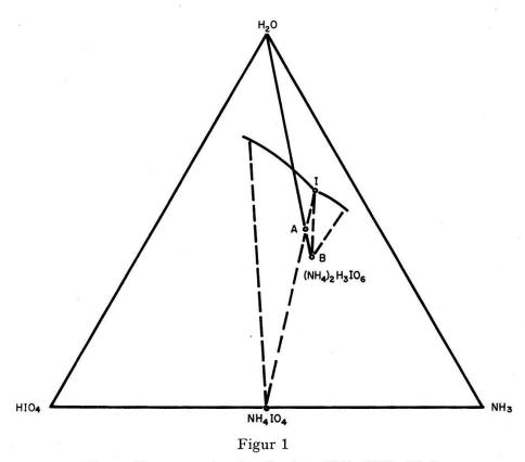
Phasendiagramm für das System  $\mathrm{NH_3-HIO_4-H_2O}$ . Löslichkeitskurven und Invarianzpunkt I sind aus Gründen der Übersichtlichkeit schematisch angegeben.
