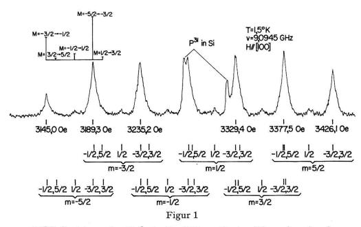
EPR-Spektrum des Mn<sup>2-</sup> in Ge. Differentiiertes Dispersionssignal  $\nu = 9094,5 \text{ MHz}, \quad T = 1,5 \,^{\circ}\text{K}, \quad H \parallel [100].$
