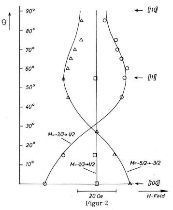
Winkelabhängigkeit von 3 der 5 Feinstrukturlinien mit m = -5/2. H  $\perp$  [110], sonst wie Figur 1.  $\bigcirc$   $\triangle$   $\square$  Experiment, —— Theorie.
