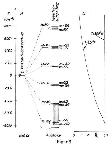
Energieeigenwerte des Operators (1) für H=3265 Oe und  $H\parallel [100]$ . Rechts Besetzung für 1,5 °K.
