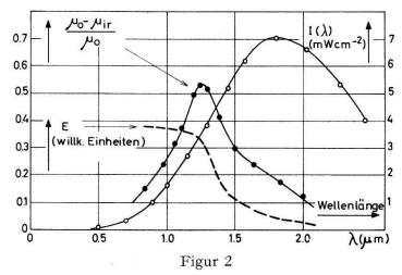
Intensität der Strahlung I ( $\lambda$ ), gemessen an der Oberfläche des Präparates; photomagnetischer Permeabilitätseffekt, ausgedrückt in der Grösse ( $\mu_0 - \mu_{ir}$ )/ $\mu_0$ ; und photomagnetischer Effekt E pro Einheit der Strahlungsintensität, als Funktion der Wellenlänge  $\lambda$ .
