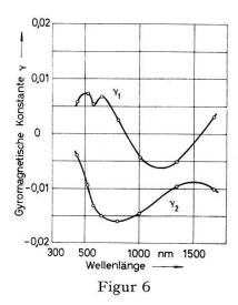
Real- (1) und Imaginärteil (2) der gyromagnetischen Konstanten von Permalloy (82,5% Ni, 17,5% Fe) in Abhängigkeit von der Wellenlänge.
