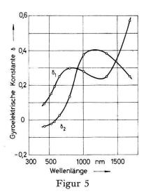
Real- (1) und Imaginärteil (2) der gyroelektrischen Konstanten von Permalloy (82,5% Ni, 17,5% Fe)in Abhängigkeit von der Wellenlänge.
