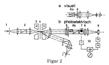
Polarimeter zur Messung des magnetooptischen Kerr- und Faraday-Effektes; 1 Lampe, 2 Glan-Thompson Prisma, 3 Magnet, 4 Probenebene, 5 Quarzkeil-Quarzblock-Kombination, 6 Halbschattenanalysator a nach Schönrock bzw. Jellet Cornu, b nach Lippich, 7 Umlaufblende, 8 Interferenzfilter, 9 Photowiderstand, 10 Verstärkerkombination mit Gleichrichter und Galvanometer.
