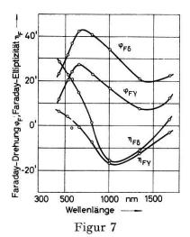
Faraday-Effekt von Permalloy (82,5% Ni, 17,5% Fe) in Abhängigkeit von der Wellenlänge; Aufspaltung in gyroelektrischen  $\delta$ - und gyromagnetischen  $\gamma$ -Anteil der Drehung  $\varphi_F$  und der Elliptizität  $\eta_F$ ; Schichtdicke  $L=33,1\,\mathrm{nm}$ ; Sättigungswerte:  $B=15\,000\,\mathrm{G}$ .
