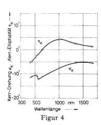
Kerr-Effekt von Permalloy (82,5% Ni, 17,5% Fe) in Abhängigkeit von der Wellenlänge; Sättigungswerte: B = 15000 G.
