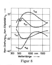
Kerr-Effekt von Permalloy (82,5% Ni, 17,5% Fe) in Abhängigkeit von der Wellenlänge an der Glasseite der Aufdampfschichten gemessen; Aufspaltung in gyroelektrischen  $\delta$  und gyromagnetischen  $\gamma$  Anteil der Drehung  $\varphi_K$  und der Elliptizität  $\eta_K$ ; Sättigungswerte:  $B=15\,000$  G.
