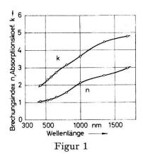
Optische Konstanten von Permalloy (82,5% Ni, 17,5% Fe) in Abhängigkeit von der Wellenlänge.
