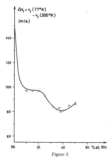
Ecart des vitesses torsionnelles entre 77 et 300 °K en fonction de la concentration en Rh.
