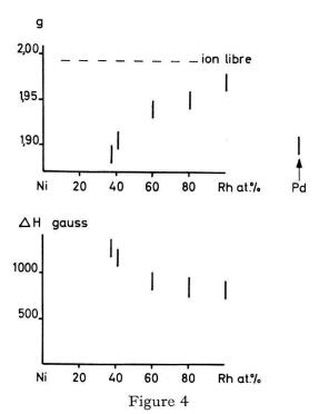
Position g de la raie du Gd dans les alliages Ni-Rh à  $T=85\,^{\circ}$ K, et largeur de raie: sa variation est corrélée au déplacement par l'effet Korringa [14].
