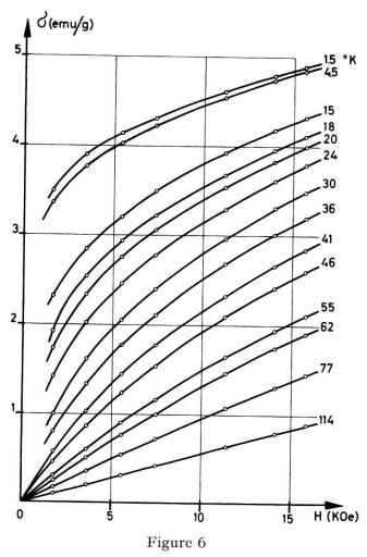
Isothermes de l'aimantation spécifique du Ni $_{.63}$ Rh $_{.37}$  en fonction du champ magnétique (corrigée des effets de désaimantation agissant sur notre échantillon sphérique). La méthode  $\sigma^2(H/\sigma)$  indique un point de Curie d'environ 20 °K.
