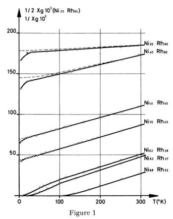
Dépendance en température de la susceptibilité spécifique réciproque des alliages Ni-Rh. Les mesures corrigées des impuretés de Fe sont illustrées par les courbes en pointillé. A noter l'échelle d'ordonnée différente pour le Ni<sub>.20</sub>Rh<sub>.80</sub>.
